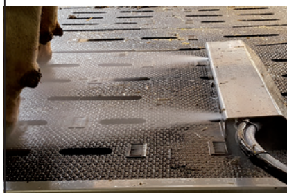
Automatische Klauenwaschanlage Bovibooster
